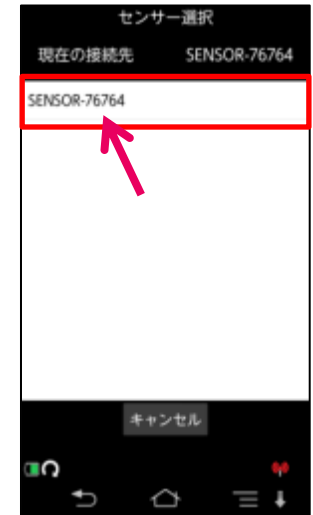
④センサーを選択して、押します。 探索画面に移行します。※セン サー本体が複数ある場合は接続 先のリストに複数表示されます。
