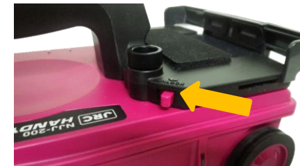
④ 取り外す際は固定レバーを矢印方向に押してスマートフォンを取り外して下さい。
