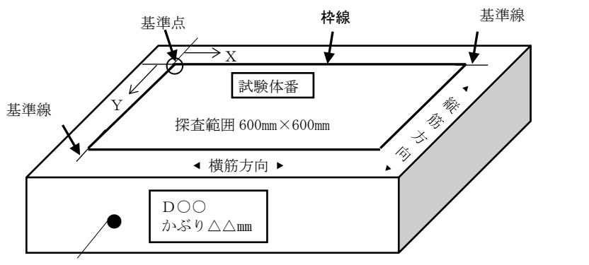
深度校正(比誘電率の設定)に使用する鉄筋(いずれかの側面に●シールで示す)
