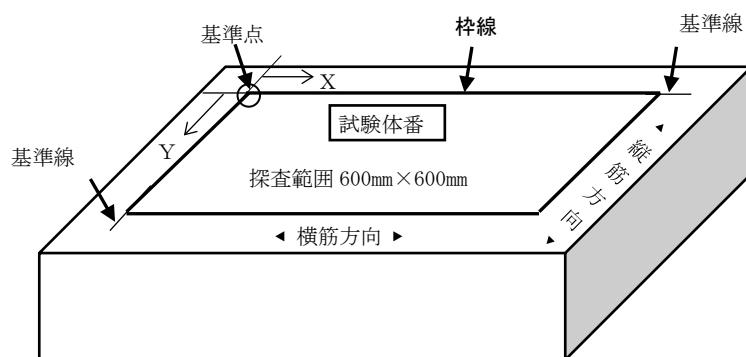
① 試験体上面に貼っているフィルムに黒の枠線で探査範囲を示しています。記入されている試験体番号を確認後、基準点と書かれたポイントが左上となるようテープを使って解答用紙を貼ってください。次に解答用紙に探査範囲の枠線（600mm×600mm）を記入します。
